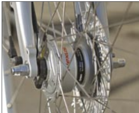
Wartungsfreier Nabendynamo, daneben die gekapselte und damit schmutzunempfindliche Rollenbremse
