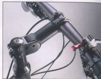
Variabel: höhen- und winkelverstellbarer Vorbau am Gudereit C90
